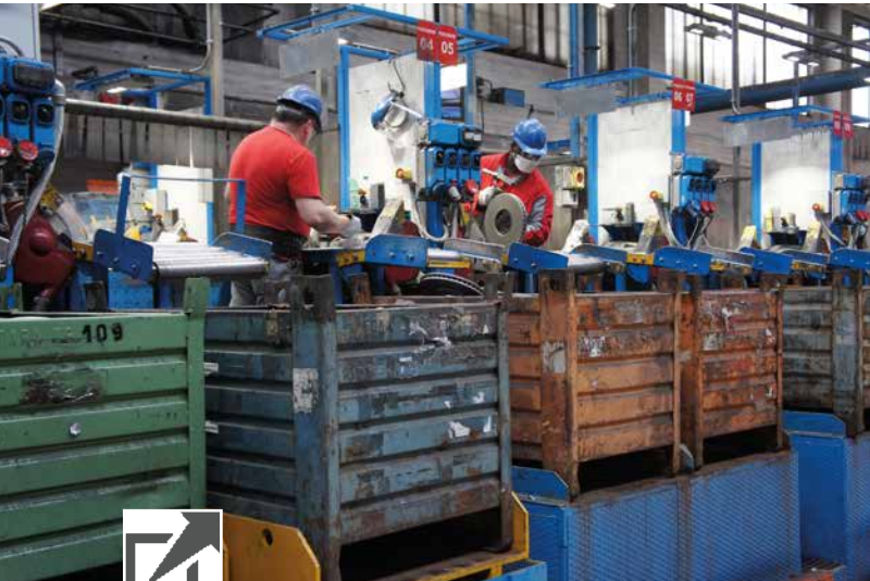
На этом участке с остывших готовых дисков сбивается облой
