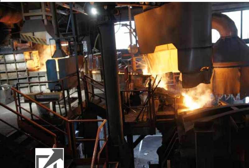
Заливка чугуна в формы. Так жидкий металл становится тормозным диском
