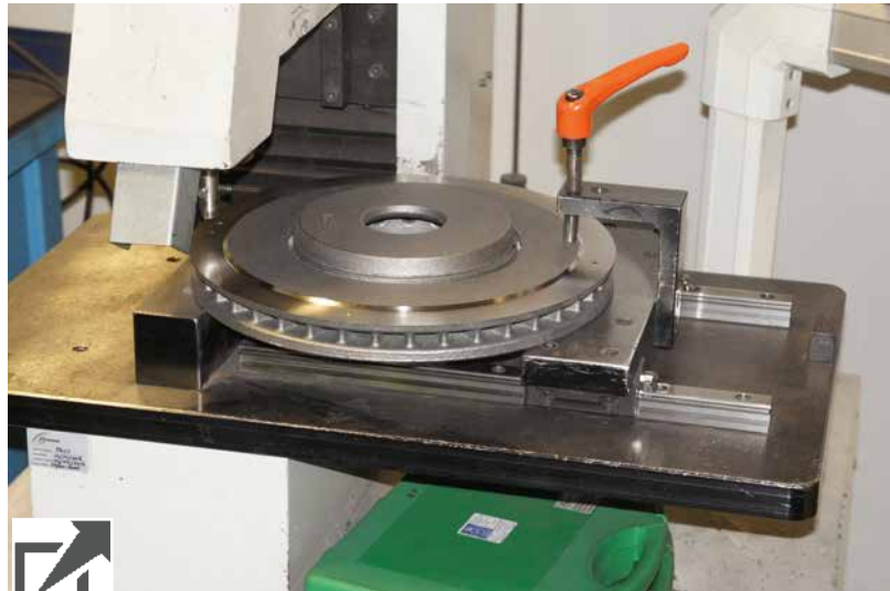
После всех операций готовые диски проходят строжайший контроль. На фото показан замер твердости поверхности по Бринеллю
