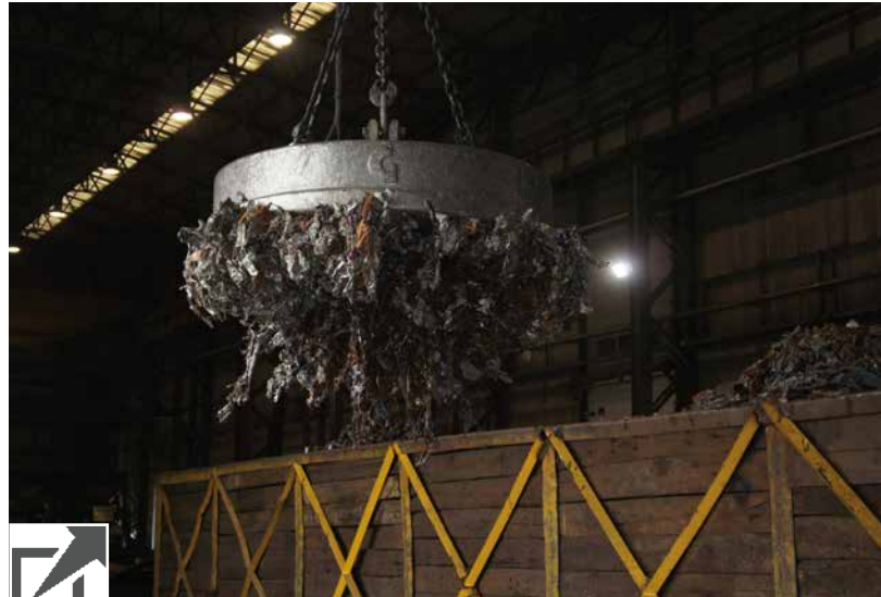
Производство литых тормозных дисков начинается со склада сырья. Магнитный кран в работе
